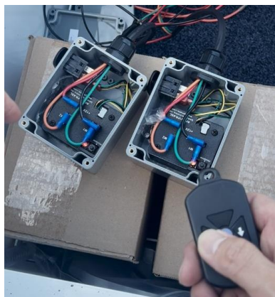
④赤色LEDランプBが点灯中にリモコンの↑ボタンを1回押します。
