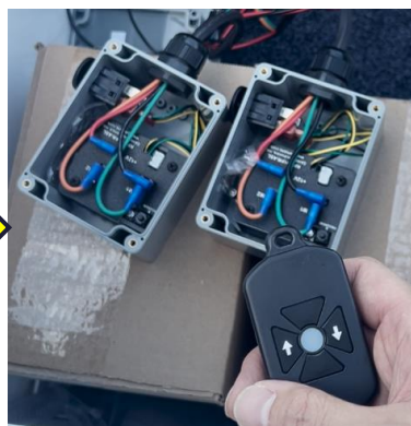
⑥LEDランプが消灯して2本のアンカーの同期が完了しリモコン一つで同時操作が可能となります。
