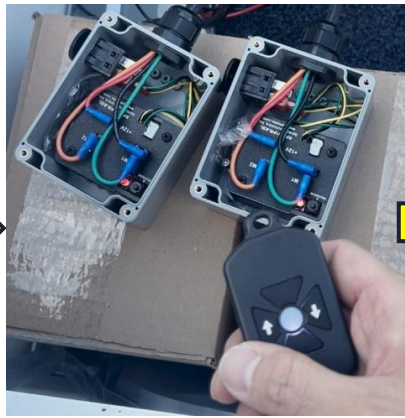
⑤リモコンとRFモジュール両方ともLEDが点滅します。
